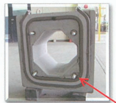
供試体の断面 高弾性接着剤 (写真は注入工法) (TBボンド)
