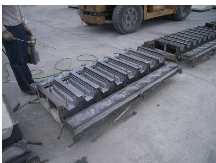
① 型枠への離型剤塗油&型組み
